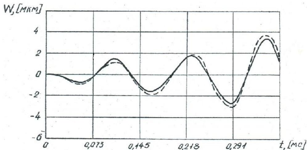
Рис. 3. Осциллограмма поверхности смещения в точке  $a$
