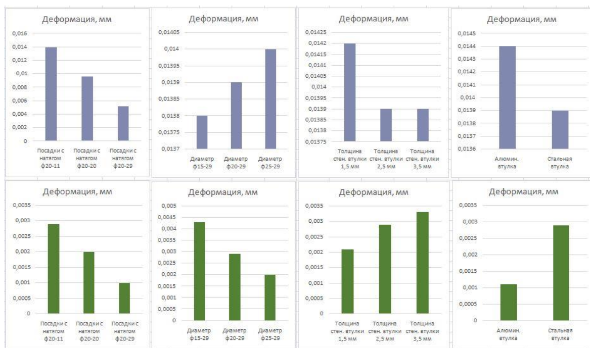
Рис. 18. Результаты расчетов метода конечных элементов втулки и вала по параметру деформация
