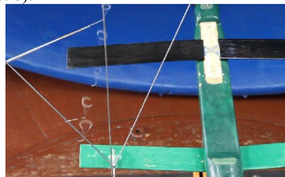
Рис. 7. Вільний вихор переднього крила при куті ковзання \beta = -5^\circ
